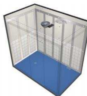
Dag 2-3. Montering av luftspaltsbildande stomme och matta.
