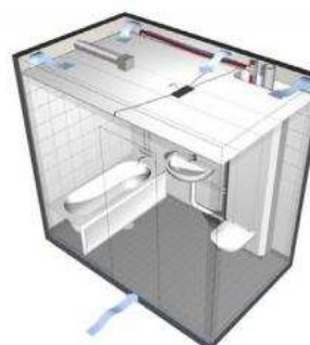
Dag 9-10. Luftspalt ansluts till befintlig ventilation.
