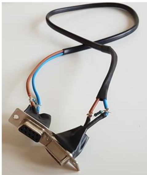
Figur 15. Överst på bilden visas schemat som användes för att kunna skapa en enkel CAN-buss. På D-sub-kontakten är pinne 2 CAN low-signalen och pinne 7 är CAN high-signalen, övriga pinnar behövde inte någon signal. Den nedre bilden visar den resulterande CAN-bussen. Fler noder kan kopplas upp på CAN-bussen mellan de båda 120 ohms motstånden. Det var viktigt att 120 ohms motstånden fanns i CAN-bussens båda ändar innan D-sub-kontakterna. Gränssnitten kopplades upp mellan var sin dator och på var sin 9 pinnars D-sub-kontakt.
