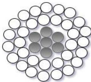
Figur 4: illustrerar tvärsnittsarea på en ferallina med 39 trådar, de gråa och vita cirkelarna representerar stål respektive aluminiumtrådar.
