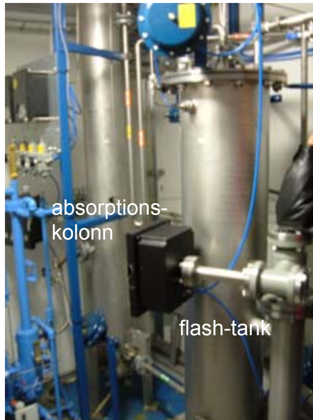
Figur 15. Absorptions- och flash-tank (foto: Johan Benjaminsson).
